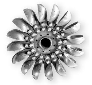
La turbine Pelton, inventée en 1879 par Lester Allan Pelton, est une turbine hydraulique à action, idéale pour des hauteurs de chute moyennes à hautes.
